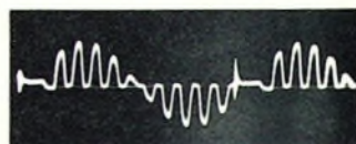
Bild 15. Farbdifferenzspannung -(U_G - U_Y) bei RGB-Ansteuerung der Farbbildröhre
